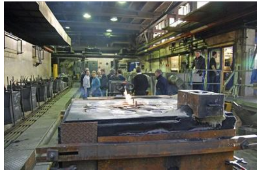
Frese Metal- og Stålstøberi i Slagelse havde meget at byde på for deltagerne på FMVs temadag om støbeprocesser. Her er vi i hjertet af virksomheden, hvor smelten hældes på formene.
